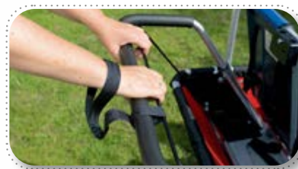
Schleife, die den Bremsbügel fest am Handgriff hält.
